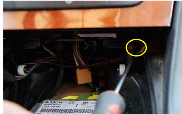
Danach kann das Bedienteil nach vorn oben abgezogen werden. Das Bedienteil dabei leicht ankippen. Anschließend den Stecker auf der Rückseite lösen.
