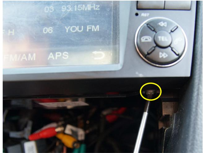
Danach kann das Radio nach vorn oben abgezogen werden. Das Radio dabei leicht ankippen. Anschließend die Stecker auf der Rückseite lösen. (Wenn noch nicht geschehen, bitte vorher die Zündung ausschalten.)
