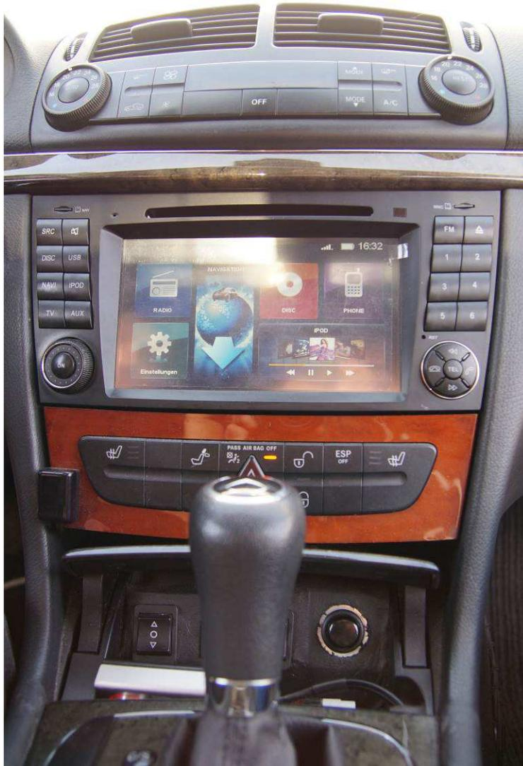
Cristian fährt eine Mercedes-Benz E-Klasse W211 mit Baujahr 2007. Er hatte ein Dynavin D99+ zusammen mit einem externen DVB-T Receiver und einem Nachrüst-Soundsystem mit einem zusätzlichen digitalen Soundprozessor installiert.
