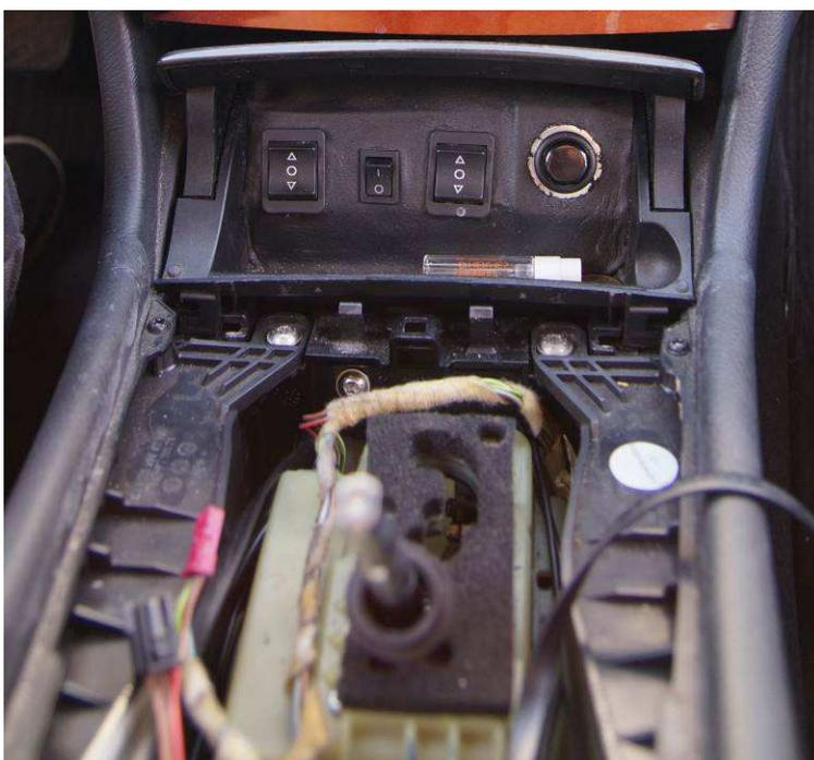
Nun wird der Aschenbechereinsatz entfernt. Den Aschenbechereinsatz können wir einfach heraus nehmen und lösen den Stecker vom Zigarettenanzünder auf der Rückseite.
