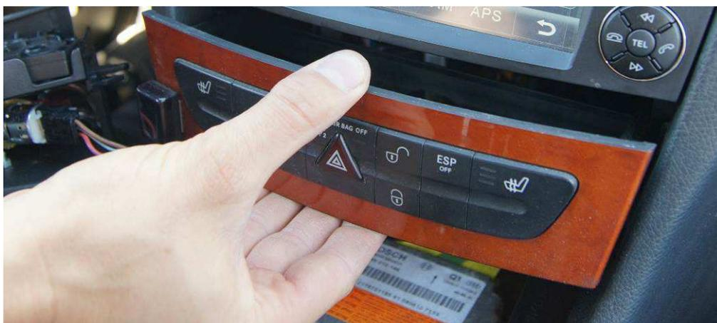
Nun kann auch das alte Radio entfernt werden. Dazu lösen wir unterhalb des Radios zwei Schrauben mit dem Torx-Schraubendreher.
